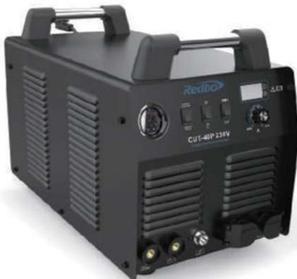
**CORTADORA DE PLASMA INVERTER 40P 220V****Voltaje de Entrada:** 50-60 [Hz]**Capacidad entrada:** 230V: 6.2[Kw]**Frecuencia:** 50-60 [Hz]**Voltaje de entrada:** 230 [V]**Voltaje salida nominal:** 96[V]**Rango corriente salida:** 230V: 15-40[A]**Ciclo de Trabajo(%):** 60**Grosor de Corte (mm):** 0.1-15**ARC start:** HF**Presión de gas sugerida:** 4-4.5**Eficiencia(%):** 85**Factor de potencia:** 0.73**Clase de aislamiento:** F**Clase de protección:** IP21S**Dimensión:** 57X34X43 cm
