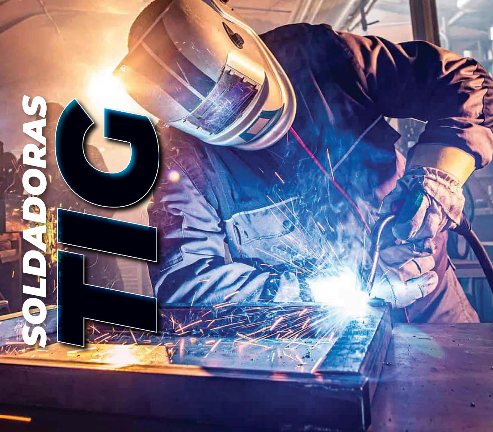
La soldadura TIG, procedente de las siglas en inglés Tungsten Iner Gas o GTAW (Gas Tungsten Arc Welding), es el proceso por el que se establece un arco eléctrico entre un electrodo de tungsteno y la pieza de trabajo que se pretende unir. Para ello, se requiere la protección de un gas o mezcla de gases.
