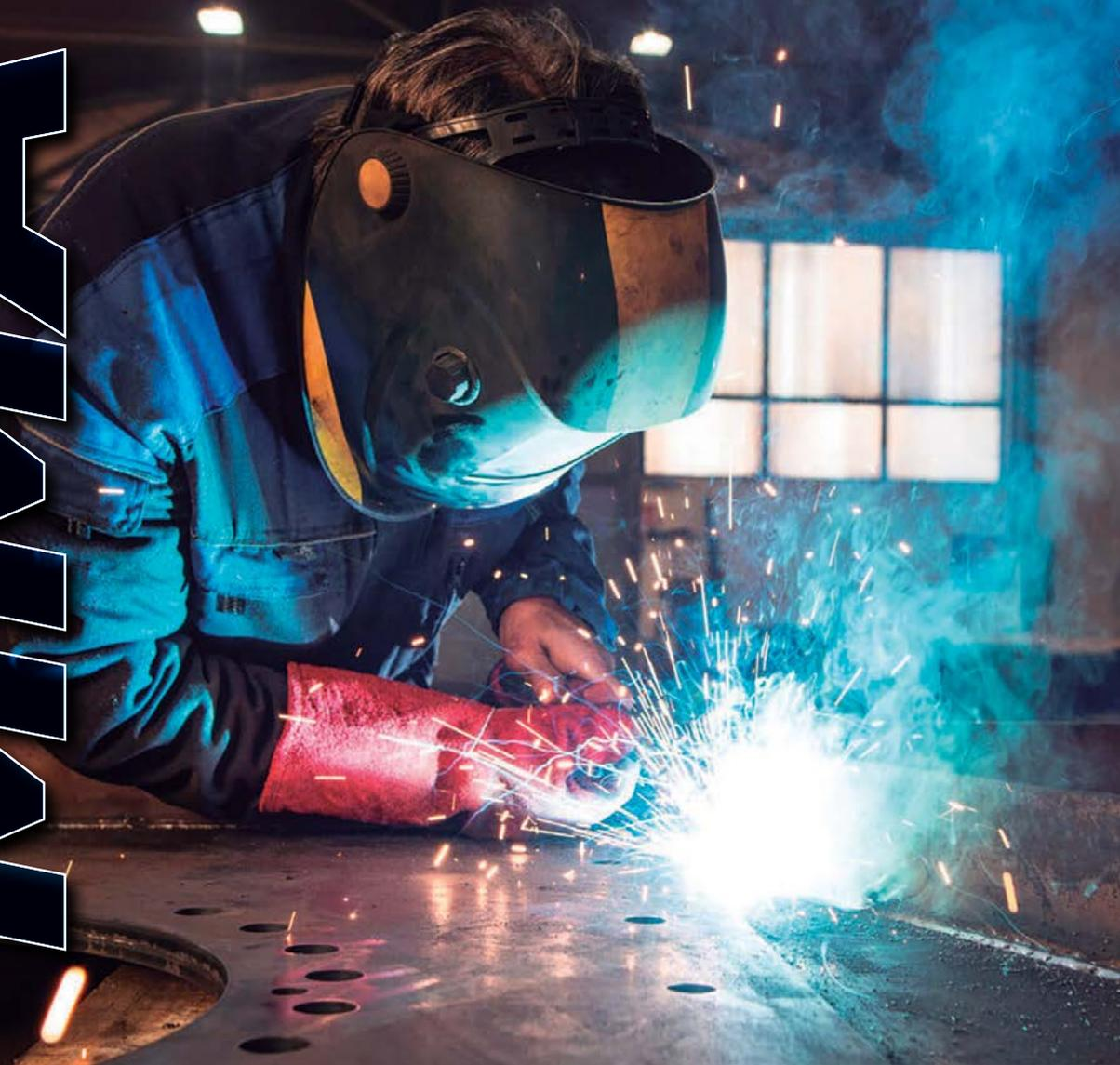
La soldadura MMA o Manual Metal Arc es un tipo de soldadura por arco con electrodo revestido. Se le conoce así porque durante el proceso se aplica electricidad y se forma un arco entre el electrodo y el material a soldar. Como resultado, el electrodo se funde y queda adherido a la unión soldada.
