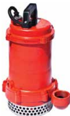
*Impulsor cerrado de plástico *Patente No. 18052-Opcional 3F 440V (Clase 1699x10) *Cuerpo en hierro fundido *Motor seco
